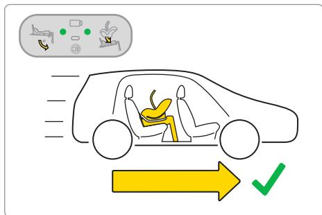
Πριν ξεκινήσετε ένα ταξίδι με το παιδί σας, δοκιμάστε το πλεκτρονικό σύστημα της βάσης. Αφού το κάθισμα στερεωθεί σωστά και το πόδι τοποθετηθεί σωστά, στην οθόνη θα εμφανιστούν δύο πράσινα σημεία.
