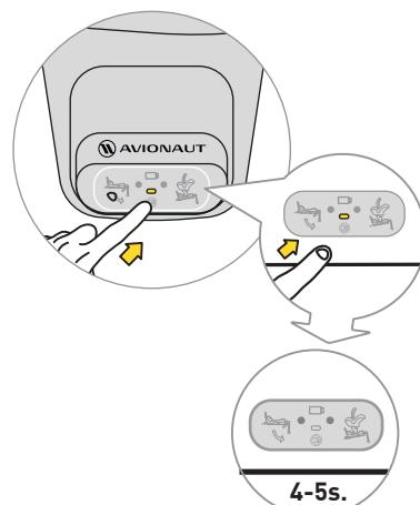
Щоб вимкнути звук, натисніть кнопку дисплея протягом 4-5 секунд. На дисплей все одно відображатиметься правильний/неправильний ремінь безпеки та кріplення основи, але звук буде вимкнено.
