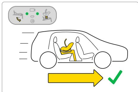
Enne lapsega reisile asumist testige aluse elektroonilist süsteemi. Kui iste on korralikult kinnitatud ja jalj on õigesti paigaldatud, ilmub ekraanile kaks rohelist punkti.
