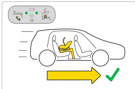
Prima di partire per un viaggio con il tuo bambino, prova il sistema elettronico della base. Dopo che il sedile è stato fissato correttamente e la gamba è stata installata correttamente, sul display appariranno due punti verdi.
