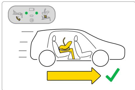
Avant de partir en voyage avec votre enfant, testez le système électronique de la base. Une fois le siège correctement fixé et le pied correctement installé, deux points verts apparaîtront sur l'écran.
