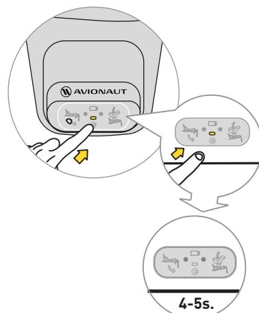
Per disattivare l'audio, premere il pulsante del display per 4-5 secondi. Il display mostrerà ancora la cintura di sicurezza corretta/sbagliata e l'attacco della base, ma l'audio verrà disattivato.
