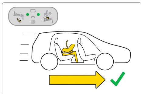
Antes de emprender un viaje con su hijo, pruebe el sistema electrónico de la base. Una vez que el asiento esté correctamente colocado y la pata instalada correctamente, aparecerán dos puntos verdes en la pantalla.
