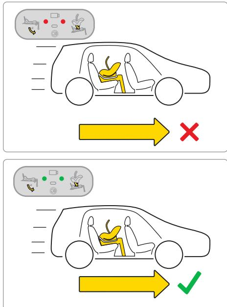
Çocuğunuzla yolculuğa çıkmadan önce baz istasyonunun elektronik sistemini test edin. Koltuk düzgün bir şekilde takıldıktan ve ayak da doğru şekilde takıldıktan sonra ekranda iki yeşil nokta görünecektir.
