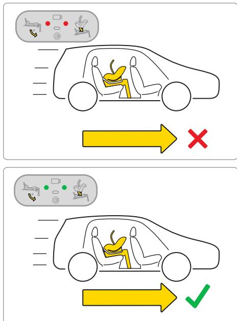
Innan du ger dig ut på en resa med ditt barn, testa basens elektroniska system. Efter att sätet är ordentligt fastsatt och benet är korrekt installerat, kommer två gröna punkter att visas på displayen.
