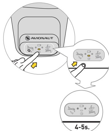
Um den Ton stummzuschalten, drücken Sie die Displaytaste 4-5 Sekunden lang. Auf dem Display werden weiterhin der richtige/falsche Sicherheitsgurt und die Basisbefestigung angezeigt, der Ton wird jedoch stummgeschaltet.
