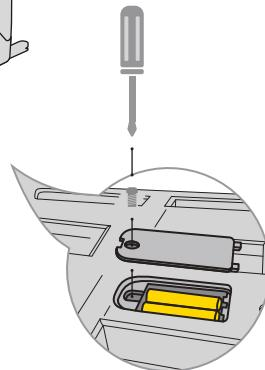
Εάν η ένδειξη μπαταρίας στην οθόνη είναι πορτοκαλί, πρέπει να αντικατασταθεί. Για να το κάνετε αυτό, αφαιρέστε το κάλυμμα στη βάση και αφαιρέστε τις μπαταρίες.
