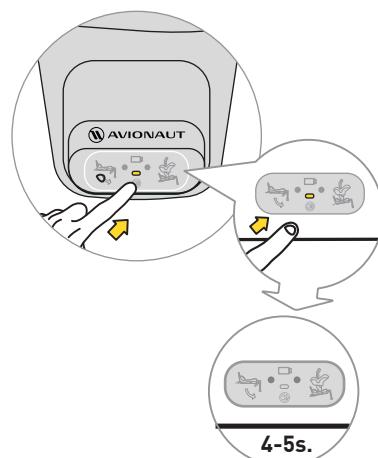
W celu wyciszenia dźwięku należy przytrzymać przycisk wyświetlacza przez 4-5 sekund. Wyświetlacz nadal będzie pokazywać prawidłowe/błędne zapięcie fotelika samochodowego oraz bazy, natomiast dźwięk zostanie wyciszony.
