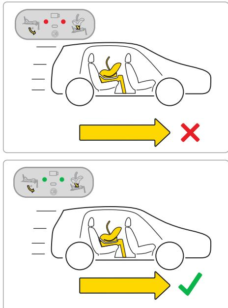
Mielőtt kirándulni indulna gyermekével, tesztelje a bázis elektronikus rendszerét. Az ülés megfelelő rögzítése és a láb megfelelő felszerelése után két zöld pont jelenik meg a kijelzőn.
