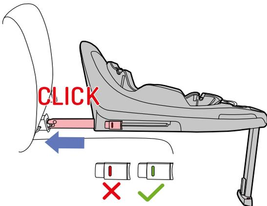
Alignez les connecteurs (15) avec les guides ISOfix (22) et poussez jusqu'à entendre un clic. Les indicateurs des boutons (14) des deux côtés doivent devenir verts. Si l'un ou les deux indicateurs sont rouges, réessayez. Vérifiez que la base est bien ancrée en tirant dessus.
