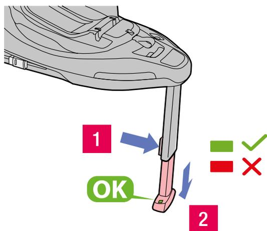
Na koniec należy rozłożyć podpórę (18) tak, aby zetknęła się z podłogą pojazdu. Naciśnij przycisk (20), aby odblokować nogę i przesunąć ją na ziemię. Zwolnij przycisk (20) i kontynuuj rozciąganie, aż do ponownego zablokowania. Jeśli podpierasz się prawidłowo, na wskaźnikach nożnych (21) pojawią się dwa zielone sygnały.
