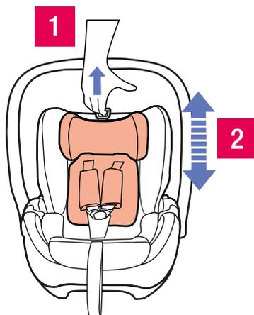
Aby wyregulować wysokość, należy pociągnąć za pierścień znajdujący się na środku głowy.
