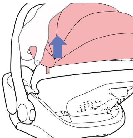
Vous pouvez retirer la capuche en la tirant par les côtés. Pour réinstaller, insérez les deux bornes dans le boîtier derrière les œillets du rembourrage.
