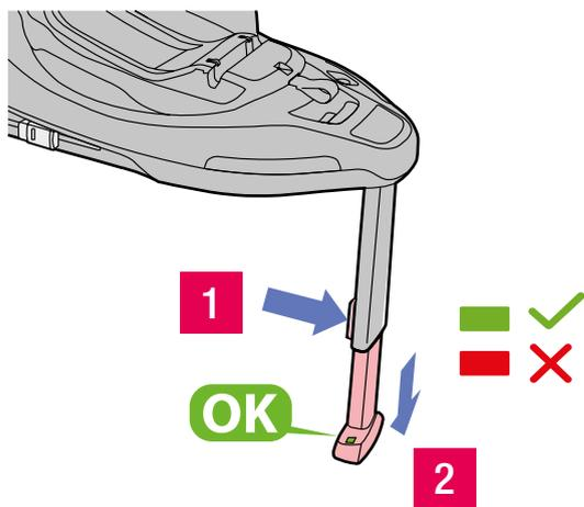
Para terminar, debe extender la Pata de apoyo (18) hasta que haga contacto con el suelo del vehículo. Presione el botón (20) para desbloquear la pata y deslícela hasta el suelo. Suelte el botón (20) y siga extendiendo hasta que se bloquee de nuevo. Si apoya correctamente, en los indicadores del pie (21) se verán dos señales de color verde.
