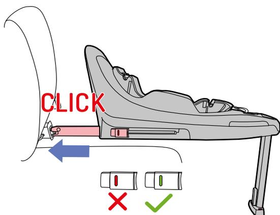
Zarovnejte konektory (15) s vodítky ISOfix (22) a zatlačte, dokud neuslyšíte cvaknutí. Indikátory tlačítek (14) na obou stranách by měly svítit zeleně. Pokud jeden nebo oba indikátory svítí červeně, zkuste to znovu. Zatažením zkontrolujte, zda je základna pevně ukotvena.
