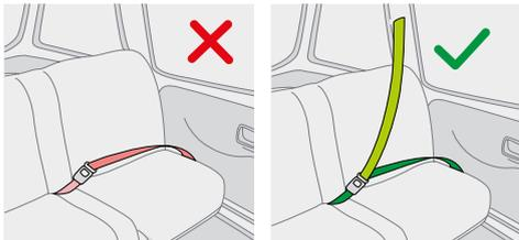
**Attention!** N'installez pas ce siège sur des sièges de véhicule dotés d'une ceinture sous-abdominale ou à 2 points. La chaise KOMBIBABY doit être installée avec des ceintures 3 points avec enrouleur.
