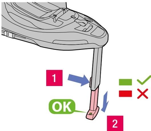
Zum Schluss müssen Sie das Stützbein (18) ausfahren, bis es den Fahrzeugboden berührt. Durch Drücken der Taste (20) wird das Bein entriegelt und auf den Boden geschoben. Den Knopf (20) loslassen und weiter ausfahren, bis er wieder einrastet. Bei richtiger Unterstützung erscheinen zwei grüne Signale an den Fußindikatoren (21).
