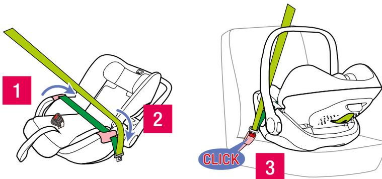
Posiciona el Seient a la plaça del vehicle on s'ha d'instal·lar. Passeu la sivella del cinturó per sobre dels peus de la KOMBIBABY inseriu només la part del cinturó abdominal a través de les dues guies del cinturó als laterals (5) i tanqueu la sivella del cinturó.
