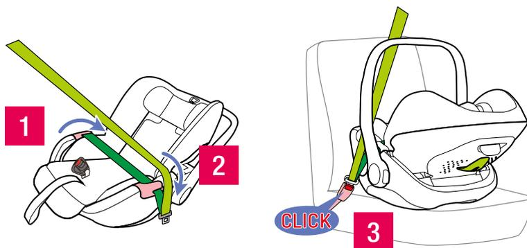
Coloque o assento no quadrado do veículo onde será instalado. Passe a fivela do cinto sobre os pés da KOMBIBABY, insira apenas a parte abdominal do cinto através das duas guias do cinto nas laterais (5) e aperte a fivela do cinto.
