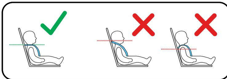
Regularnie sprawdzaj, czy pasy naramienne są ustawione na odpowiedniej wysokości, w zależności od rozmiaru dziecka.
