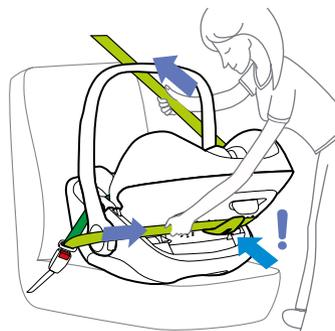
Führen Sie den Schulterteil des Gurtes über den Kopf des Babys und stecken Sie ihn in den Führungsschlitz (9) in der Rückenlehne. Ziehen Sie den Sicherheitsgurt fest an und lassen Sie den Aufroller Ihres Autos das überschüssige Gurtspiel ausgleichen. Überprüfen Sie, dass die Riemen nicht verdreht oder locker sind.
