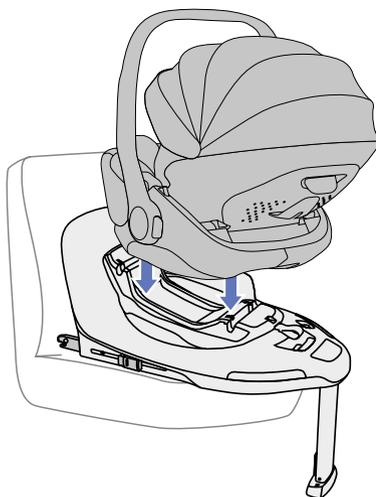
Dipositeu el portabebès sobre la base procurant direccionar els dos eixos del portabebès sobre els 4 ancoratges de la base.
