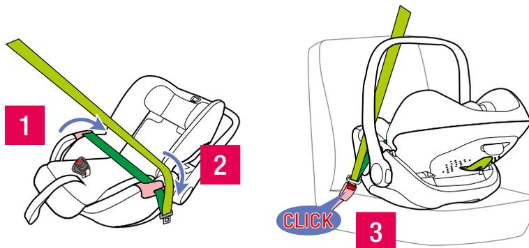
Positionnez le siège sur le carré du véhicule où il va être installé. Passez la boucle de ceinture sur les pieds du KOMBIBABY, insérez uniquement la partie de la ceinture abdominale à travers les deux guides de ceinture sur les côtés (5) et serrez la boucle de ceinture
