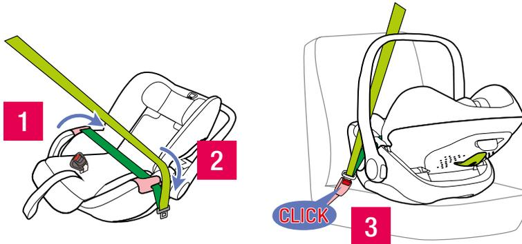
Positionieren Sie den Sitz auf der Fläche des Fahrzeugs, in der er installiert werden soll. Führen Sie die Gurtschnalle über die Füße des KOMBIBABY, stecken Sie nur den Bauchgurt-Teil durch die beiden seitlichen Gurtführungen (5) und ziehen Sie die Gurtschnalle fest
