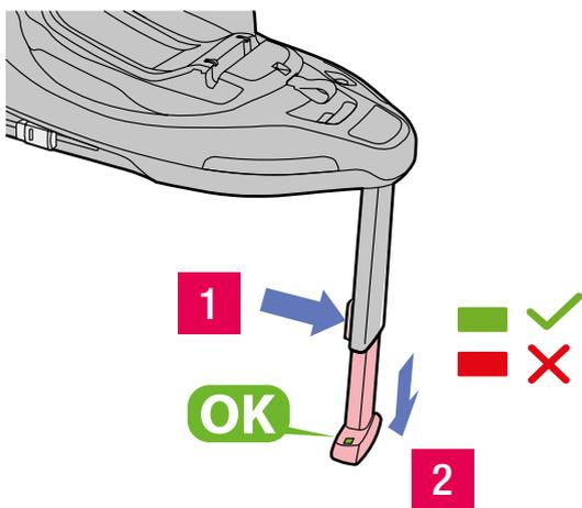
Per a acabar, ha d'estendre la Pota de suport (18) fins que faça contacte amb el sòl del vehicle. Pressione el botó (20) per a desbloquejar la pota i esten-la fins al sòl. Solte el botó (20) i continue estenent fins que es bloquege de nou. Si secunda correctament, en els indicadors del peu (21) es veuran dos senyals de color verd.
