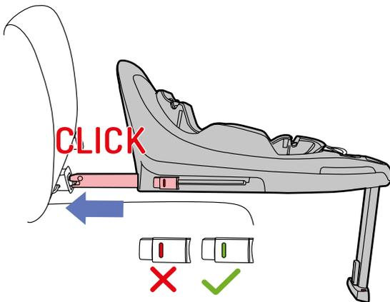
Richten Sie die Verbinder (15) an den ISOfix-Führungen (22) aus und drücken Sie, bis Sie ein Klicken hören. Die Tastenanzeigen (14) auf beiden Seiten sollten grün leuchten. Wenn eine oder beide Anzeigen rot sind, versuchen Sie es erneut.
