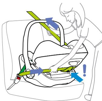
Passez la partie d'épaule de la ceinture sur la tête du bébé et insérez-la dans la fente de guidage (9) du dossier. Serrez bien la ceinture de sécurité et laissez l'enrouleur de votre voiture prendre le relais. Vérifiez que les courroies ne sont pas tordues ou desserrées.
