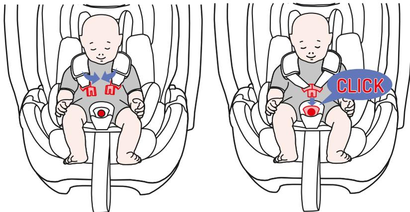
Placez le bébé dans le siège et attachez le harnais. Joignez d'abord les extrémités des bretelles, puis insérez-les dans la boucle jusqu'à ce que vous entendiez un clic.
