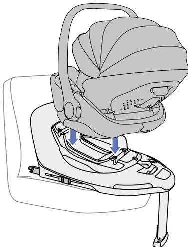
Deposite el portabebés sobre la base procurant adreçar els dos eixos del portabebés sobre els 4 ancoratges de la base.
