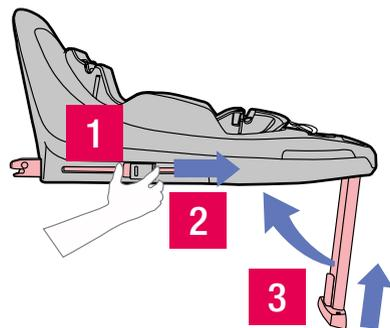
Zum Abnehmen der Basis drücken Sie die Knöpfe (14) an den Isofix-Verankerungen. Dieser Knopf verfügt über eine Sicherung, um eine versehentliche Manipulation zu verhindern. Zum Lösen müssen Sie beide Seiten der Taste drücken.
