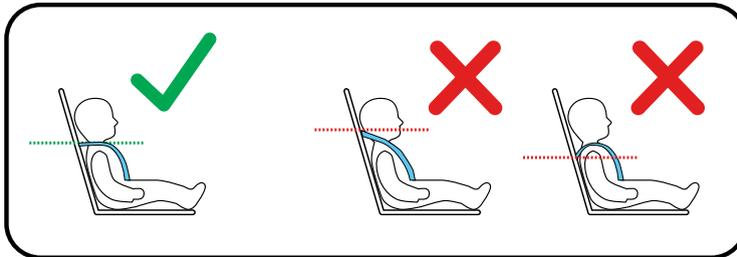
Überprüfen Sie regelmäßig, ob die Schultergurte in der passenden Höhe entsprechend der Größe des Babys angebracht sind. Die Höhe der unteren Kante der Kopfstütze sollte auf gleicher Höhe wie die Schultern liegen.
