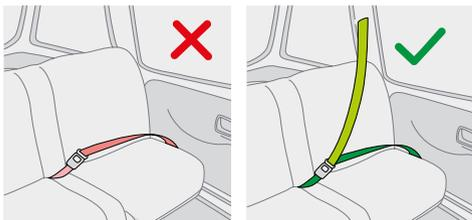
**Uwaga!** Nie należy montować tego fotelika na siedzeniach pojazdu, w których znajduje się pas biodrowy lub dwupunktowy. Fotelik KOMBIBABY należy montować za pomocą pasów 3-punktowych z mechanizmem zwijającym.
