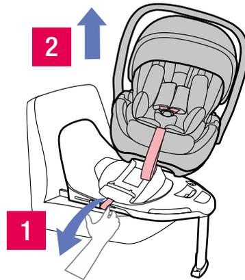
Um die Babytrage von der Basis zu lösen, können Sie diese leichter in die Trageposition drehen. Ziehen Sie es nach oben, während Sie am Trennband (16) ziehen.
