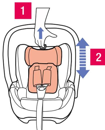
Para ajustar esta altura, tire de la anilla en el centro del cabezal.
